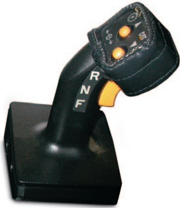
**Control de dirección STIC™.** El control STIC™ combina la selección de velocidad y sentido de marcha y la dirección en una sola palanca para aumentar al máximo la eficiencia. Un movimiento lateral sencillo gira la máquina hacia la izquierda o la derecha. Los cambios de la transmisión (avance/neutral/retroceso) se controlan usando un interruptor basculante de tres posiciones. El botón de cambios ascendentes o descendentes operado por el pulgar controla los cambios manuales.
