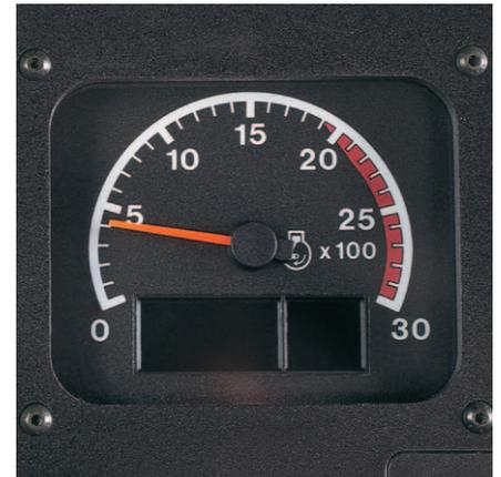
**• Módulo de velocímetro/tacómetro.** Supervisa tres sistemas: velocidad del motor, velocidad de desplazamiento e indicador de marchas.
