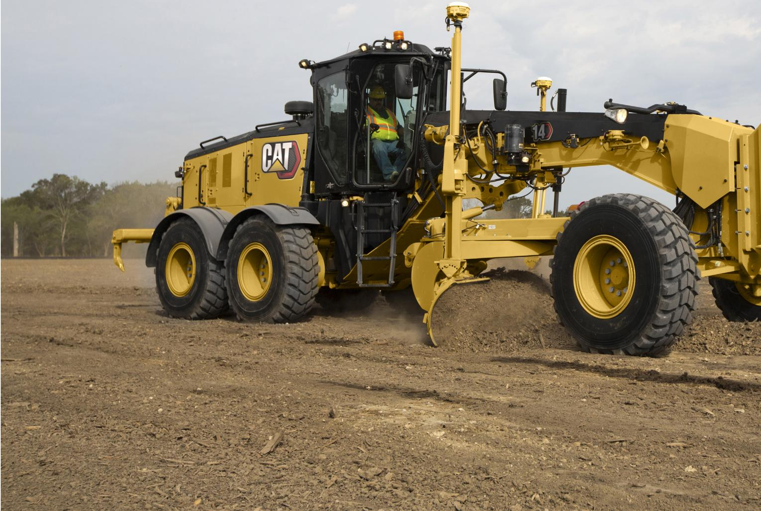
Tanto el cilindro de la dirección del eje delantero como los protectores de detección están diseñados para mejorar la durabilidad, y las mangueras hidráulicas se dispusieron para mejorar la fiabilidad.
