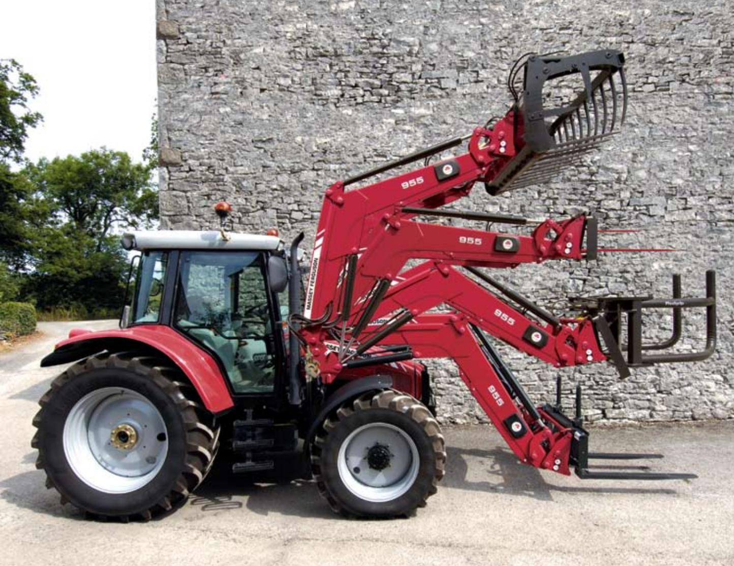
**01** El sistema semiautomático "Lock & Go" agiliza y simplifica la conexión de la pala cargadora.
