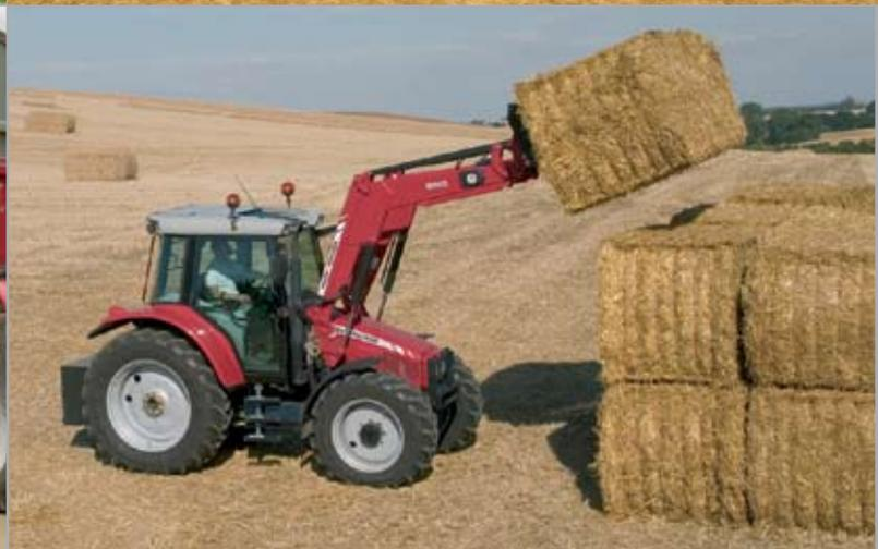
En todos los modelos los bastidores auxiliares de la pala cargadora están diseñados para garantizar que se pueda acceder fácilmente al espacio de mantenimiento. La pala cargadora puede bloquearse en posición elevada de forma segura; alternativamente el sistema "Lock & Go" permite que cualquiera de las palas cargadoras de la serie MF 900 pueda retirarse rápidamente para poder acceder al tractor.
