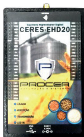
5 - Equipamento EHD20 - Leitura da termometria digital.
