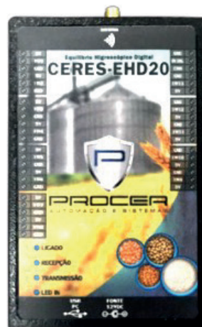
5 - Equipamento EHD20 - Leitura da termometria digital.
